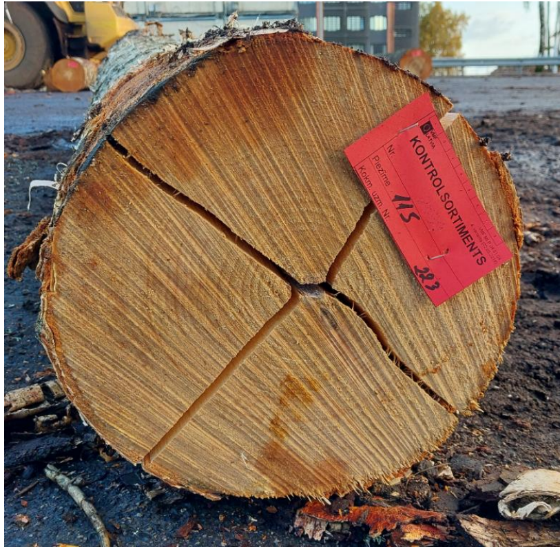
4. att. Serdes un žūšanas plaisas, kas šķeļ bērza finierkluča sānu virsmu (kontrolsortiments pārstrādes vietā)
